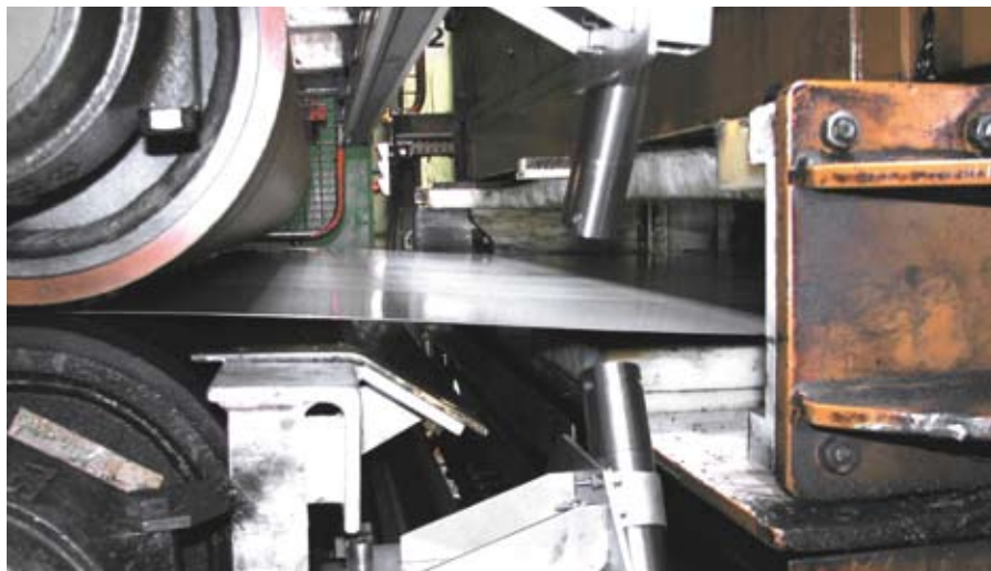
Traversiereinrichtung mit Messköpfen im betrieblichen Einsatz Installation location of the traversing system with detection heads
